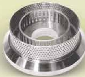
マルチステージ 内側 スロット型ステーター 外側 角穴ハイシアースクリーン
